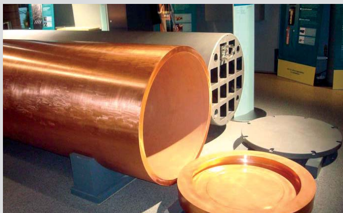
Skandinávské úložné kontejnery s měděnou vnější obálkou (Zdroj: Posiva)
