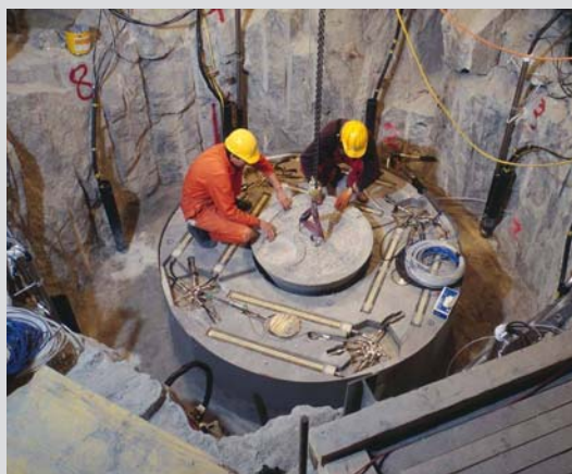
Experimentální zařízení k výzkumu migrace plynů v horninovém masivu v podzemní laboratoři Grimsel (Zdroj: Nagra/Comet Photoshopping)
