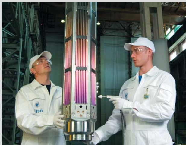
Kazeta čerstvého jaderného paliva společnosti TVEL, používaná v jaderné elektrárně Temelín (Z továrny na výrobu paliva MSZ – Mashinostroitelny zavod)
