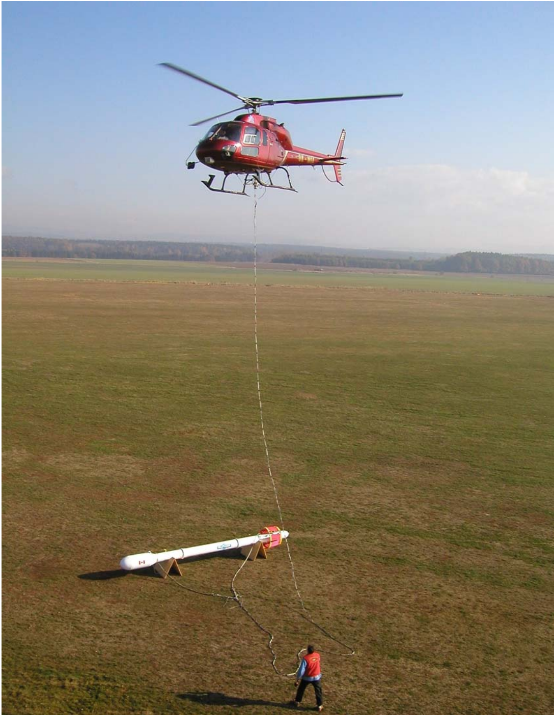
Obr. 2: Helikoptéra s elektromagnetickým snímačem HUMMINGBIRD na 30 m laně
